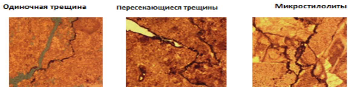
Рис. 4. Трещины в вакстоунах исследуемого месторождения Сорокинского НГР (составлено М.Е. Шабуровой, 2024 г.)
